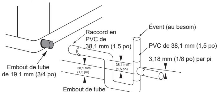
Sur les unités horizontales à débit inférieur, un embout en PVC ou un tube en acier inoxydable est fourni pour le raccord de la tuyauterie de vidange du condensat. Un piège externe est requis (voir ci-dessous). Si un événement est nécessaire, un tuyau à support ouvert peut être appliqué sur un raccord en T dans la tuyauterie de condensat installée sur place.
