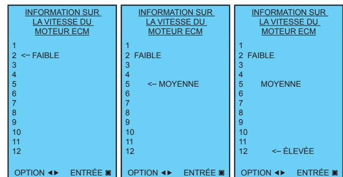
Une fois le réglage de la vitesse élevée sélectionné, l'outil AIDE retourne automatiquement à l'écran de configuration du moteur ECM.
